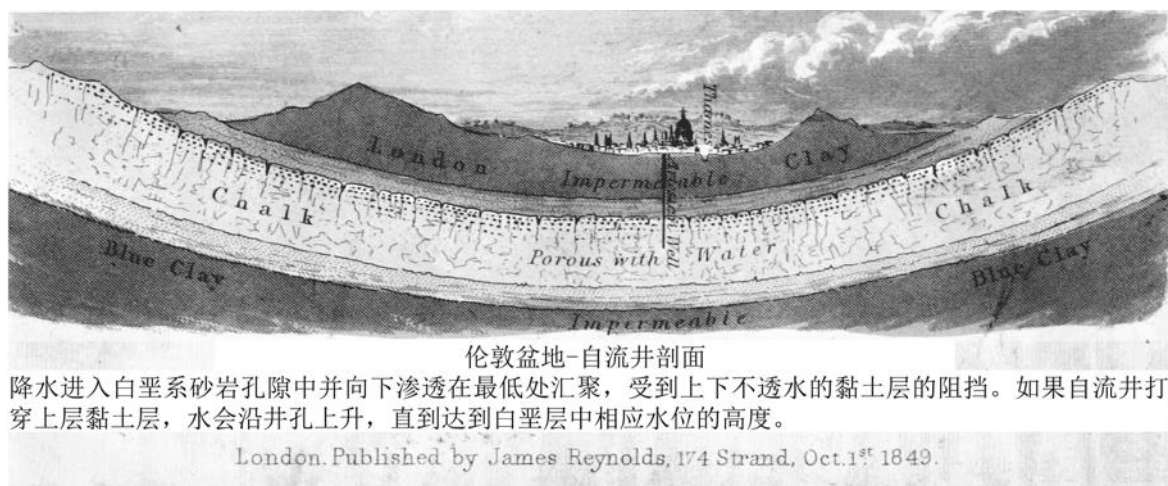
图 7 - 伦敦盆地自流井剖面图（Morris, 1849）。图中文字解释了自流井形成的原因（转引自 Mather, 2013）。
