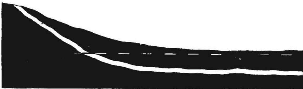
图 5 – 承压含水层对自流井控制的示意图（Garnier, 1822; 转引自 Versluys, 1930）。
