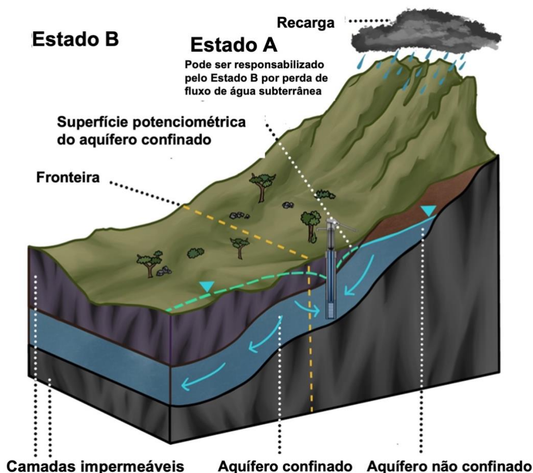
Figura 59 - O Estado A bombeia vazões elevadas do aquífero em seu lado da fronteira no Modelo E, produzindo mudanças na superfície potenciométrica da zona confinada e nas direções de fluxo da água subterrânea. Nas proximidades do poço, esse bombeamento pode reverter a direção do fluxo natural da água subterrânea através da fronteira, fazendo com que a água flua do Estado B para o Estado A dentro da área de influência do poço. Dependendo do grau de dano que o Estado B sofrer com a redução do fluxo de água subterrânea em seu território, o Estado B pode ter uma reivindicação de responsabilidade contra o Estado A, demandando reparação.
