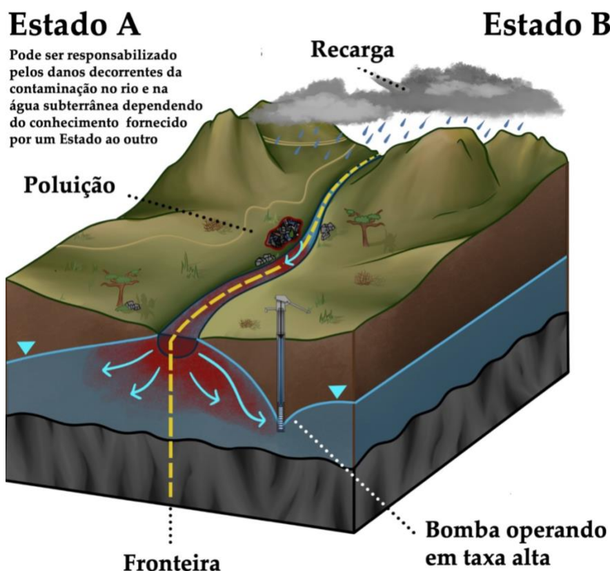
Figura 25 - O Estado B bombeia a uma vazão elevada no Modelo A com um rio influente, e a poluição é introduzida diretamente no rio no Estado A. Esta poluição migra através do leito do rio para o aquífero. O fluxo de água subterrânea e a pluma de poluição são mostrados ao longo da seção transversal A1 na parte frontal desta imagem. A área de influência do poço de bombeamento do Estado B alcança o rio, aumentando o fluxo de água do rio para o aquífero no Estado B e reduzindo o fluxo no rio. Como resultado, isso intensifica o fluxo de poluição do rio para a porção do aquífero no Estado B. Isso cria uma base para a responsabilidade do Estado A perante o Estado B e os usuários do rio a jusante pelas consequências do rio poluído. A responsabilidade pelos danos e impactos causados no aquífero do lado da fronteira do Estado B depende não apenas das condições hidrológicas, mas também de circunstâncias adicionais, como o conhecimento fornecido por um Estado ao outro. Por exemplo, o Estado A pode ser responsável pelas consequências de um rio e aquífero contaminados; no entanto, se o Estado B soubesse da contaminação antes do bombeamento, isso poderia enfraquecer sua reivindicação. Por outro lado, se o Estado A não notificasse o Estado B sobre a poluição, isso poderia fortalecer a reivindicação do Estado B.
