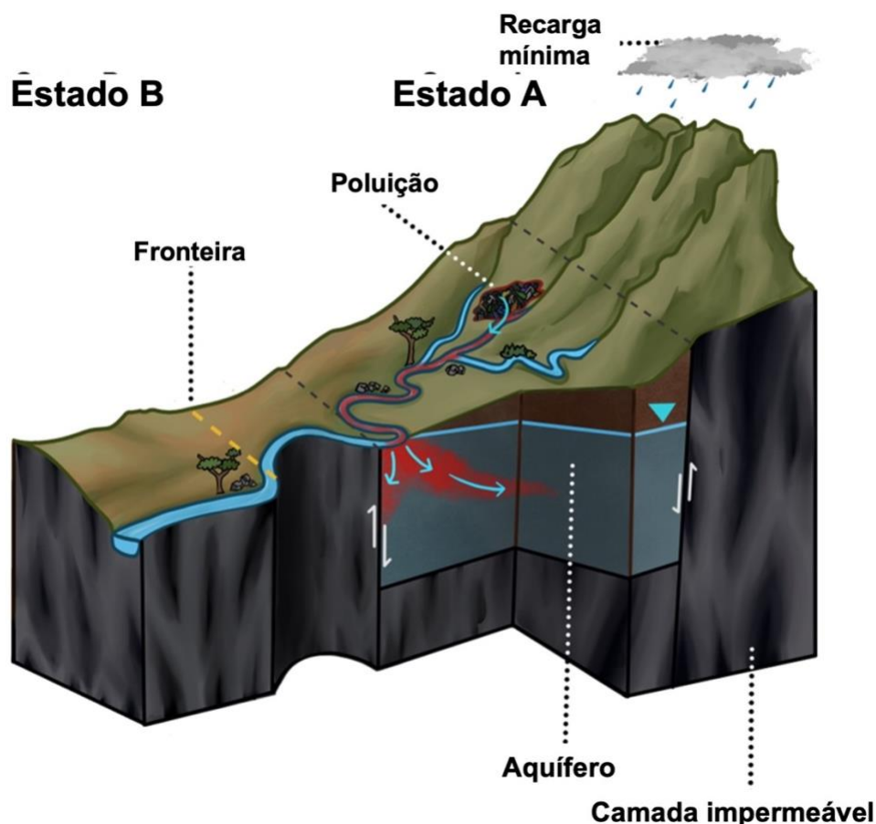
Figura 57 - Diagrama mostrando um rio transfronteiriço em uma relação de perda para um aquífero localizado inteiramente dentro do estado ribeirinho superior do rio (Estado A). Qualquer poluição introduzida no rio no Estado A seria—pelo menos parcialmente—removida do rio antes de chegar ao Estado B devido à infiltração do rio no aquífero do Estado A.
