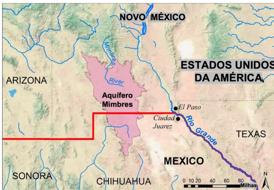
Figura 50 - Mapa da extensão geográfica do aquífero transfronteiriço Mimbres. O aquífero livre está hidrologicamente conectado ao Rio Mimbres, que flui inteiramente dentro dos EUA e tem uma relação de perda com o aquífero (reproduzido de Rodriguez, 2022d).
