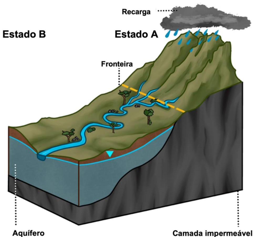
Figura 51 - Modelo D: Um rio que atravessa uma fronteira internacional e está hidrologicamente conectado a um aquífero livre localizado completamente dentro do território do Estado a jusante do curso d'água.
