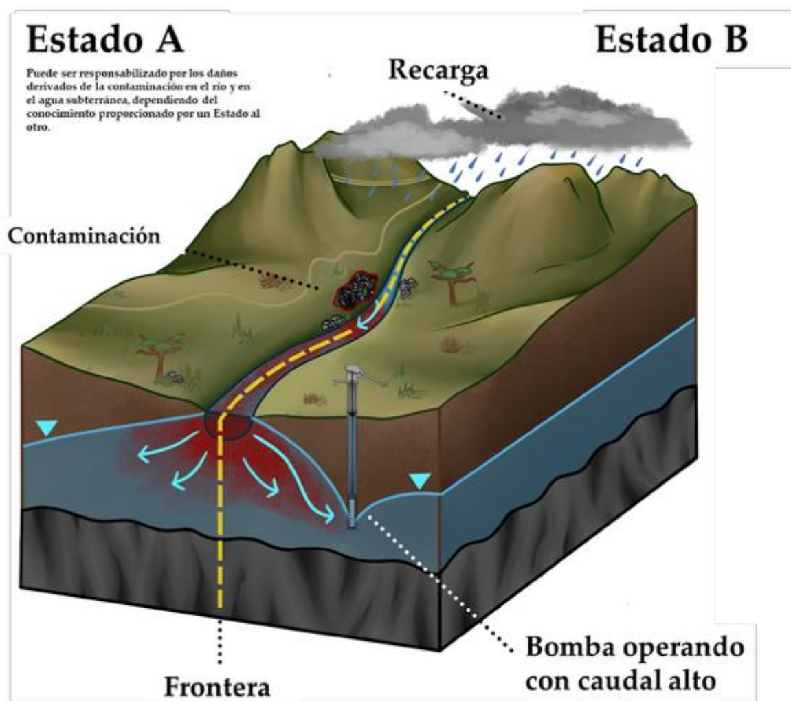
Figura 25 - El Estado B bombea a un caudal alto en el Modelo A con un río influente, y la contaminación se introduce directamente en el río en el Estado A. Esta contaminación migra a través del lecho del río hacia el acuífero. El flujo de agua subterránea y la pluma de contaminación se muestran a lo largo de la sección transversal A1 en la cara frontal de esta imagen. El área de influencia del pozo de bombeo del Estado B alcanza el río, aumentando el flujo de agua del río hacia el acuífero en el Estado B y reduciendo el flujo en el río. Como resultado, se intensifica el flujo de contaminación del río hacia la parte del acuífero del Estado B. Esto crea una base para la responsabilidad por reparación de daños del Estado B y los usuarios del río aguas abajo contra el Estado A por las consecuencias del río contaminado. La responsabilidad de reparación de daños por el impacto en el acuífero del lado del Estado B de la frontera depende no solo de las condiciones hidrológicas, sino también de circunstancias adicionales, como el conocimiento proporcionado por un Estado al otro. Por ejemplo, el Estado A puede ser responsable de las consecuencias de un río y un acuífero contaminados; sin embargo, si el Estado B sabía sobre la contaminación antes de bombear, eso podría debilitar su reclamación. Por otro lado, si el Estado A no notificó al Estado B sobre la contaminación, eso podría fortalecer la reclamación del Estado B.
