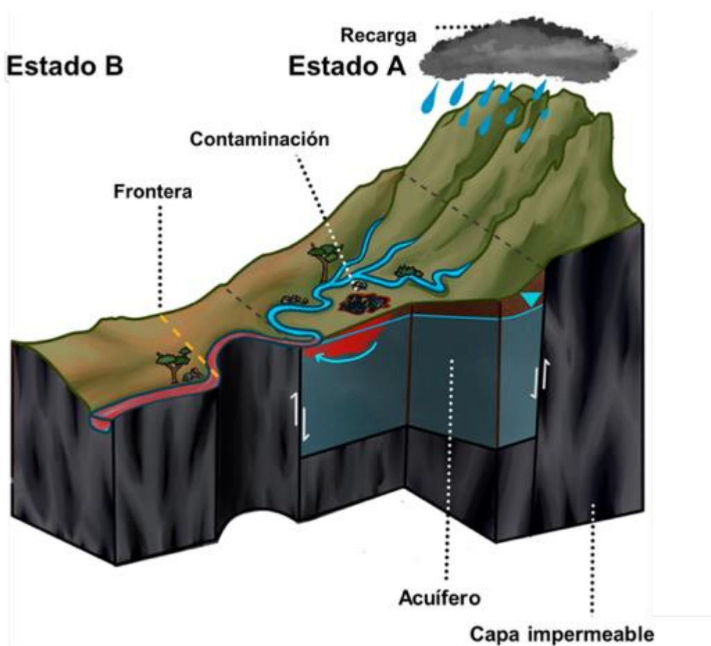
Figura 55 - Diagrama que muestra un río transfronterizo en una relación ganadora con un acuífero ubicado enteramente dentro del estado ribereño superior del río (Estado A). Cualquier contaminación que se produzca en el acuífero interno del Estado A podría migrar al río y fluir hacia el Estado B.
