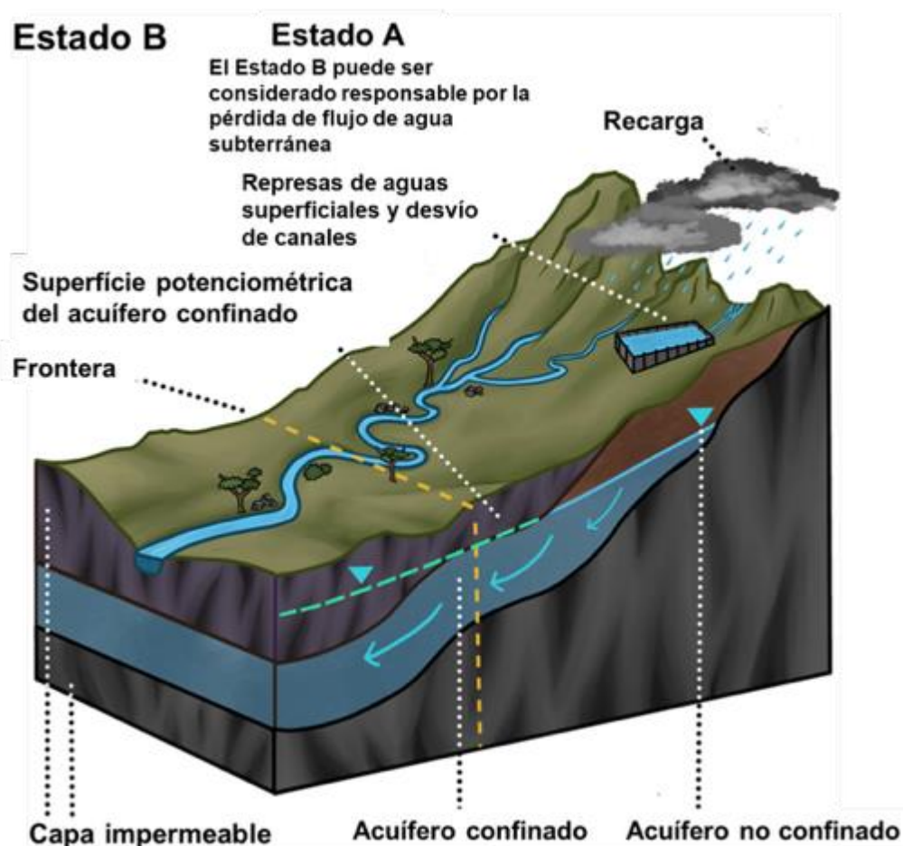
Figura 61 - El Estado A desvía agua del área de recarga a un embalse de agua superficial. Esto provoca una reducción en el volumen de agua que se infiltra en la zona de recarga y llega al acuífero, una disminución del nivel freático en el Estado A, y la consiguiente reducción del flujo a través del acuífero confinado y una disminución de su superficie potenciométrica. Dependiendo del grado de daño que sufre el Estado B por la reducción del flujo de agua subterránea en su territorio y la reducción de la presión en su porción del acuífero confinado, el Estado B puede tener un reclamo de responsabilidad contra el Estado A.
