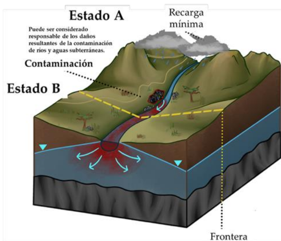
Figura 36 - En condiciones naturales (sin bombeo) en el Modelo B con un río influente, el Estado A ha contaminado el río. Las direcciones del flujo de agua subterránea a lo largo de la sección transversal B2 en el Modelo B se muestran en la cara frontal de esta imagen. Es probable que tanto el río como el agua subterránea en el Estado B estén contaminados debido a la mala condición del río influente. El Estado B tiene una posible reclamación de responsabilidad por reparación de daños debido a las consecuencias de la contaminación del río y del acuífero.
