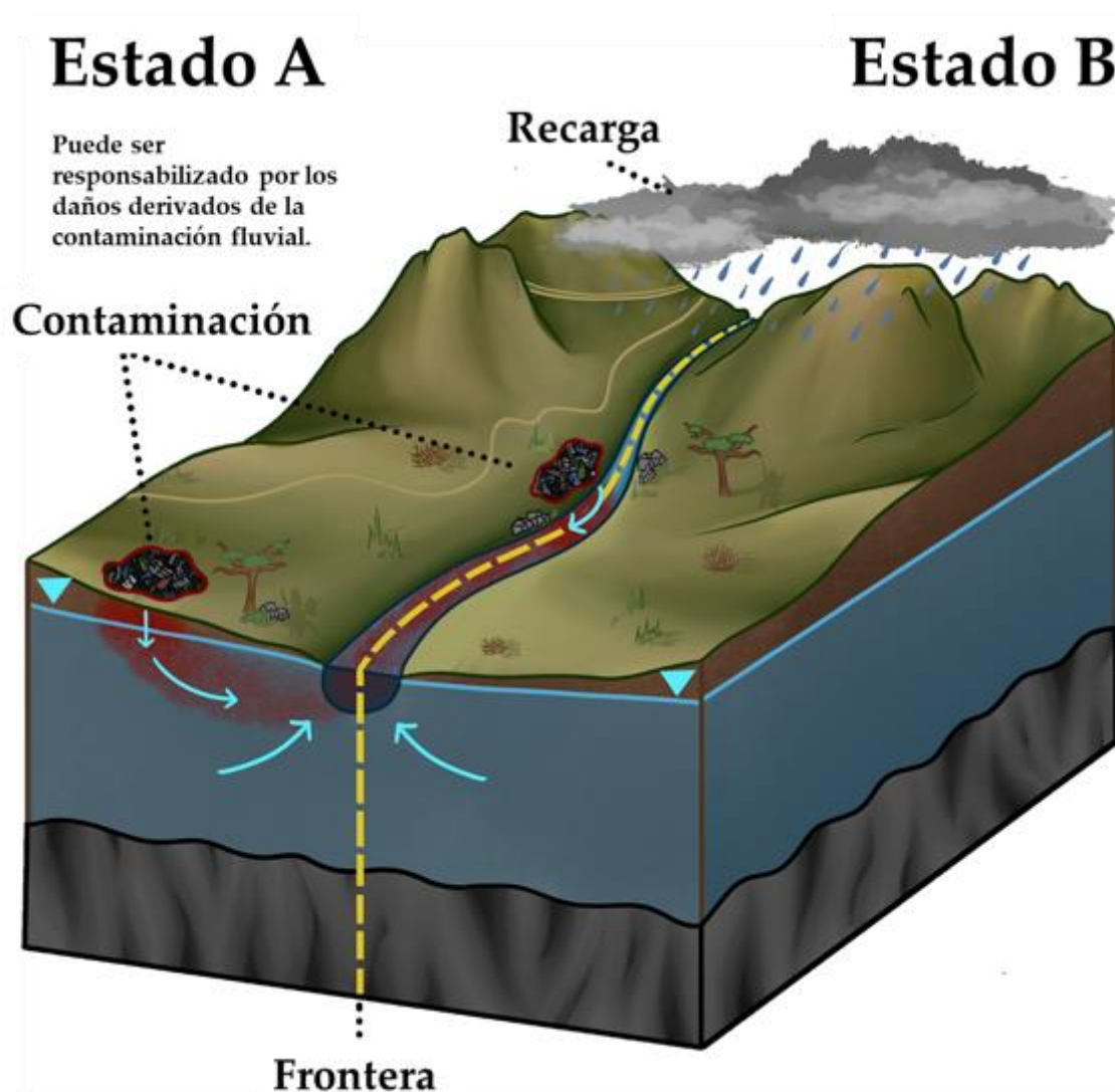
Figura 18 - Bajo condiciones naturales (sin bombeo) en el Modelo A con un río efluente (alimentado por el acuífero), la contaminación en la superficie terrestre ingresa al agua subterránea subyacente y migra hacia el río. La cara frontal de la imagen muestra el flujo de agua subterránea y la pluma de contaminación a lo largo de la sección transversal A1. El Estado B y los usuarios del río aguas abajo podrían tener un reclamo de responsabilidad contra el Estado A por las consecuencias de la contaminación en el río.
