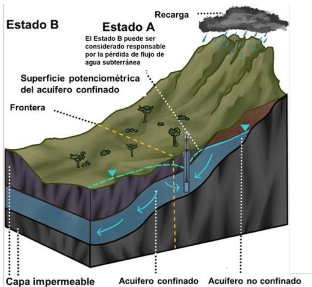
Figura 59 - El Estado A bombea a un ritmo elevado desde el acuífero en su lado de la frontera en el Modelo E, produciendo cambios en la superficie potenciométrica de la zona confinada y en las direcciones del flujo del agua subterránea. En las proximidades del pozo, este bombeo puede invertir la dirección del flujo natural del agua subterránea a través de la frontera, provocando que el agua subterránea fluya del Estado B al Estado A dentro del área de influencia del pozo. Dependiendo del grado de daño que sufre el Estado B por la reducción del flujo de agua subterránea en su territorio, el Estado B puede tener un reclamo de responsabilidad contra el Estado A.
