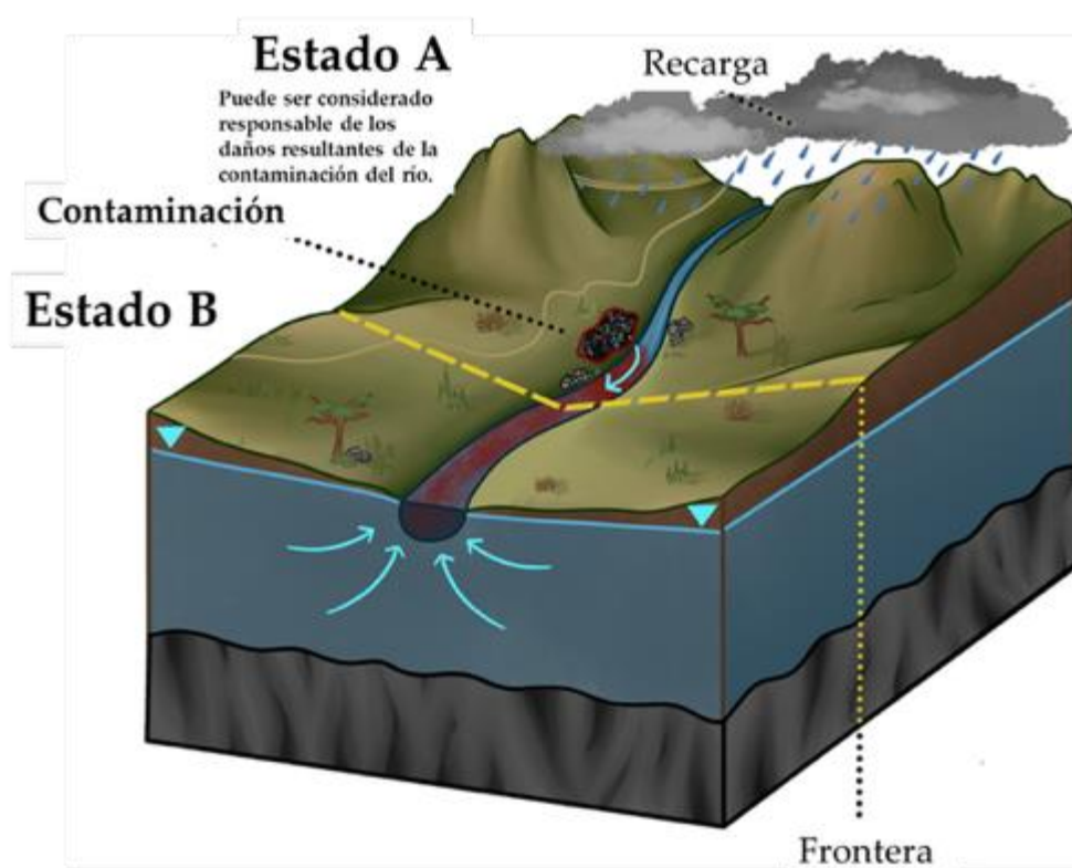
Figura 35 - En condiciones naturales (sin bombeo) en el Modelo B con un río efluente, el Estado A ha contaminado el río. Las direcciones del flujo de agua subterránea se muestran a lo largo de la sección transversal B2 en la cara frontal de esta imagen. El agua subterránea en el Estado B permanece sin contaminarse debido a la condición de río efluente, pero el río en el Estado B si está contaminado. El Estado B tiene una posible reclamación de responsabilidad por reparación de daños causados en virtud del río contaminado.
