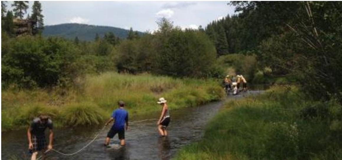
**Figura 74** - Instalação de um sensor de temperatura por cabo de fibra ótica distribuída no rio John Day, Oregon, EUA (OSU, 2020).
