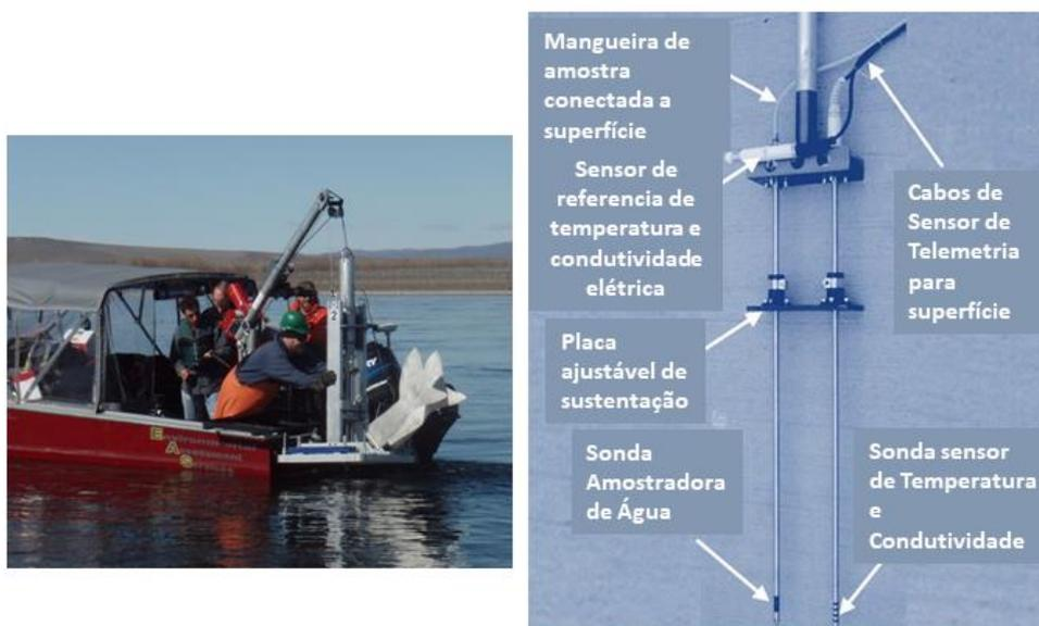
**Figura 77** - Uma amostragem de água subterrânea e sonda de temperatura ([Trident](#)) desenvolvida pela Marinha dos Estados Unidos é empurrado ou dirigido para dentro do sedimento (Steenon e Naugel, 2017).
