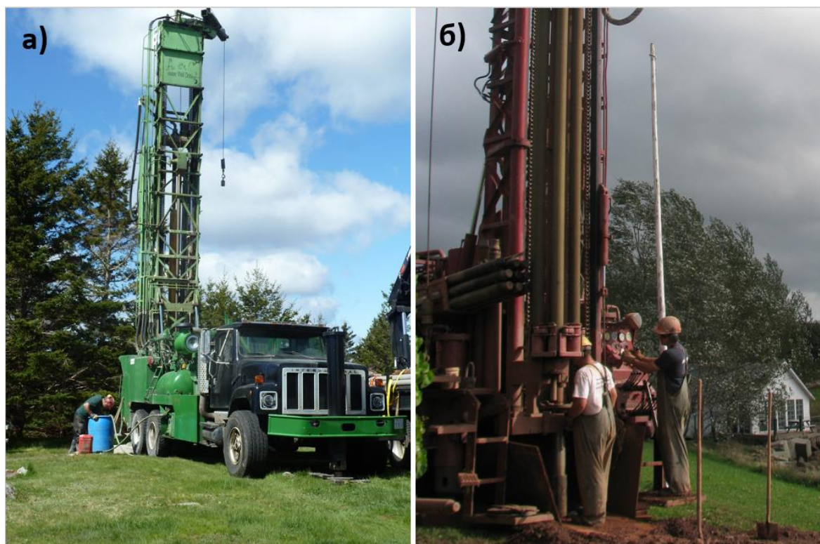
Рисунок 6 - Скважина для частного дома, пробуренная с помощью буровых установок, смонтированных на грузовиках. (Фотография а) John Drage и фотография б) Gavin Kennedy.)
