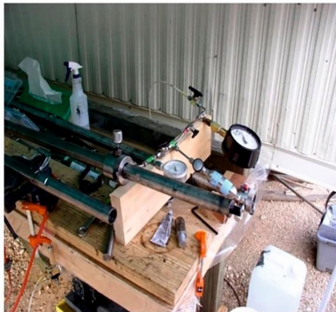
Рисунок 18 - Пробоотборник для использования при высоких температурах и давлении. Состоит из шприца объемом 1 л, который может быть опущен в скважину и открыт на определенной глубине для получения точных данных о составе подземных жидкостей и газов. а) Получение рассола и газа из пробоотборника в лаборатории Геологической службы США, б) Подготовка пробоотборника для использования в районе Фрио (Kharaka et al., 2006a, 2009).
