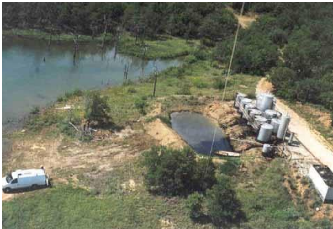
Рисунок 58 - Аэрофотоснимок части участка OSPER B, на котором показаны резервуары для жидкости и карьер с рассолом возле оз. Скиатук. Нефтяные операции привели к образованию повреждений почвы, которые частично восстановлены на участке между карьером и резервуаром (фото любезно предоставлено Кеном Джуэллом, USEPA, Ада, Оклахома; из Kharaka & Dorsey, 2005).
