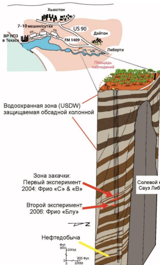
Рисунок 85 - Площадь поверхности и схематический геологический разрез района полевых испытаний Frio Brine I и II вблизи Хьюстона, штат Техас. Испытания проводились с 2004 по 2008 год с целью изучения возможностей геологического накопления CO 2 в засоленных водоносных горизонтах. По проекту Frio I в 24-метровую зону песчаника олигоценовой формации Фрио было закачано около 1600 метрических тонн CO 2 с нефтеперерабатывающего завода. Глубинные и приповерхностные пробы пластовой воды и газа отбирались как из нагнетательной скважины, так и из наблюдательной скважины 30 м глубины с использованием различных инструментов для отбора проб и аналитических методов (Kharaka et al., 2006b, 2009).
