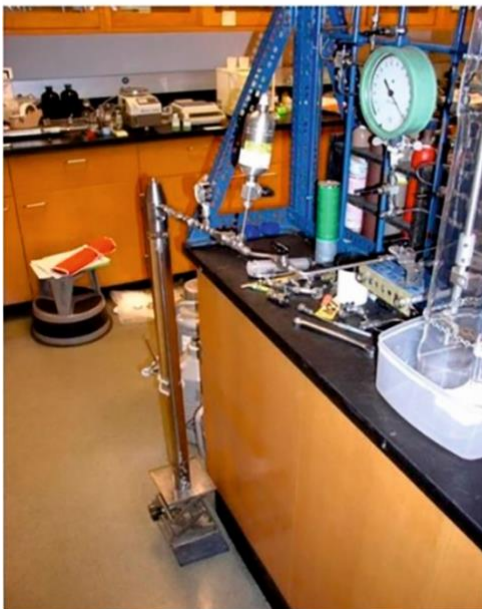
Рисунок 18 - Пробоотборник для использования при высоких температурах и давлении. Состоит из шприца объемом 1 л, который может быть опущен в скважину и открыт на определенной глубине для получения точных данных о составе подземных жидкостей и газов. а) Получение рассола и газа из пробоотборника в лаборатории Геологической службы США, б) Подготовка пробоотборника для использования в районе Фрио (Kharaka et al., 2006a, 2009).
