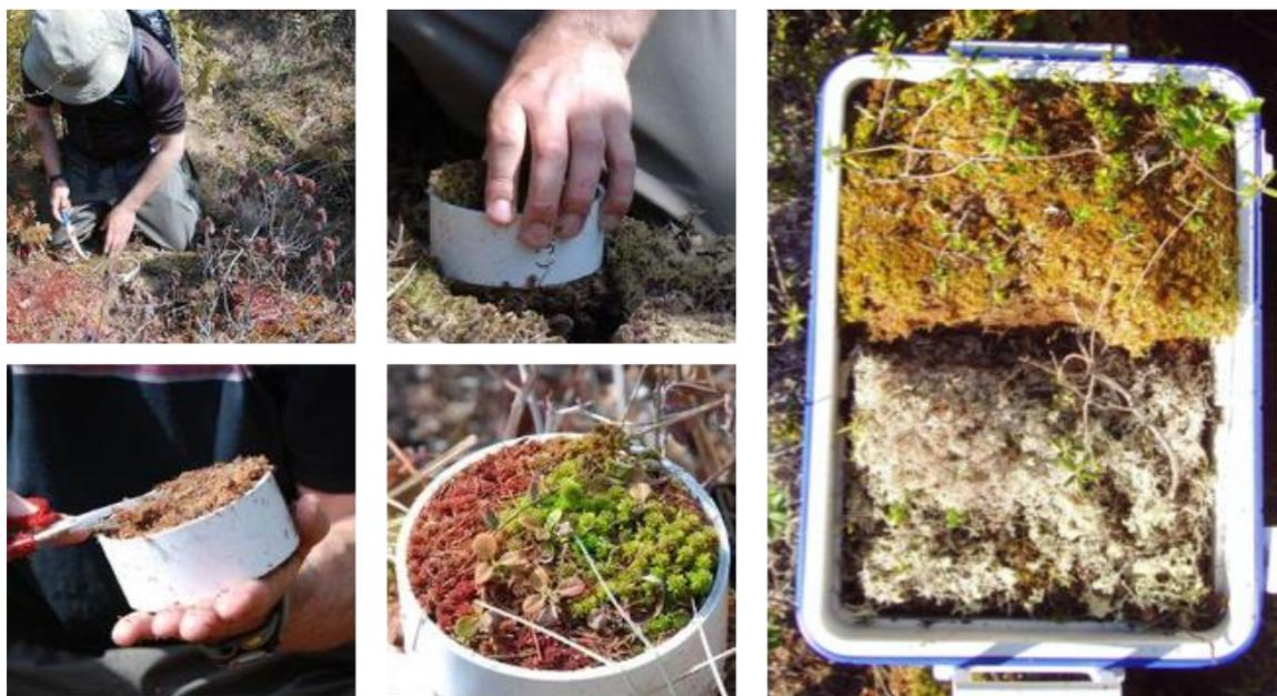
**Figura 23** - Muestreo de la capa superior de la turba de pantano utilizando un anillo de PVC de 10 cm de diámetro y 5 cm de altura, con un cuchillo y unas tijeras. Las capas inferiores pueden muestrearse secuencialmente. Las muestras más grandes pueden cortarse con cuchillos dentados o una sierra de mano; se aconseja almacenarlas en una nevera o contenedor rígido. (Fotografías de J. Price, C. McCarter y W. Quinton)
