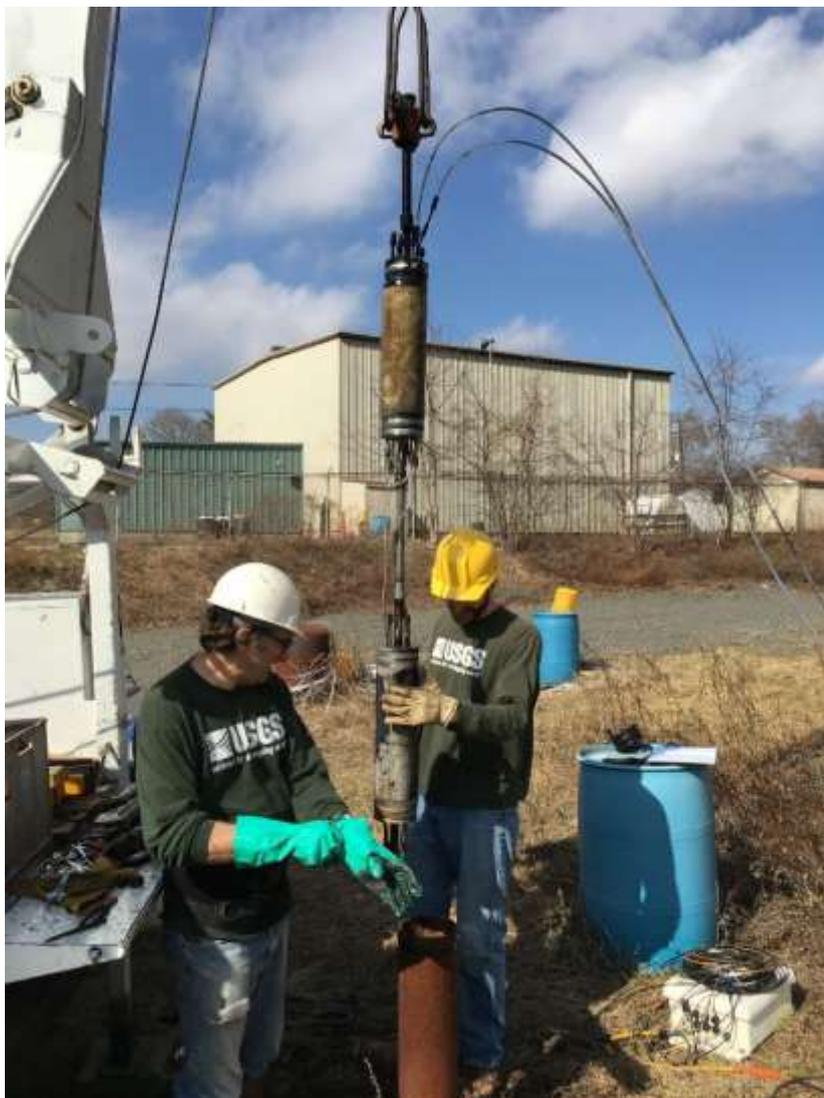
La fotografía muestra la instalación de dos sistemas de packer para aislar la sección de un pozo abierto (<http://www.usgs.gov/media/images/photograph-usgs-hydrologists-and-packers-pozo-testing>).
