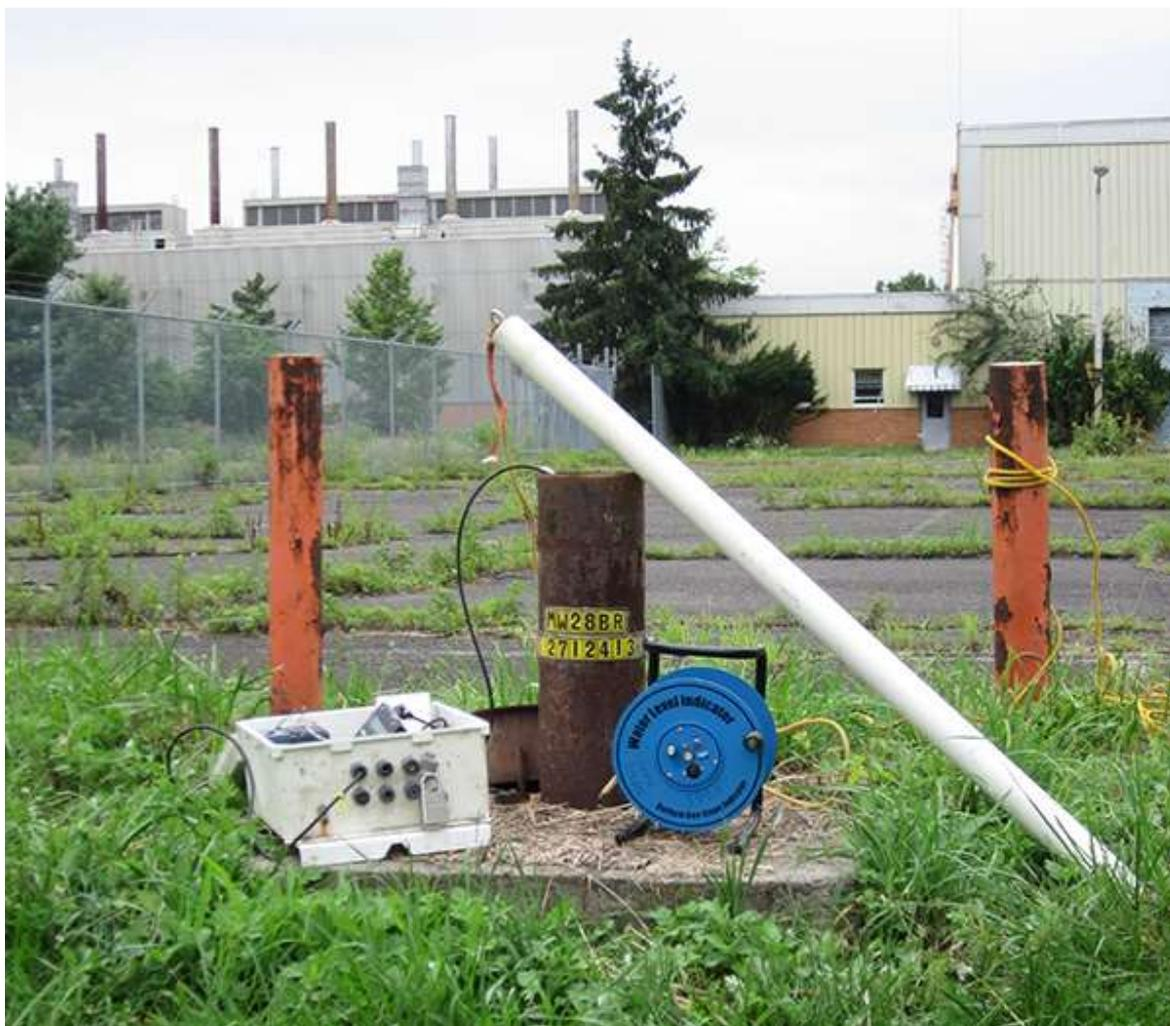
La fotografía muestra un dispositivo sólido, *slug* (PVC blanco con tapón), caja de registro de transductor de presión, y sensor de cinta eléctrica para realizar una prueba de pulso en la zona Naval del centro de Warfare, New Jersey, USA (USGS, 2014).
