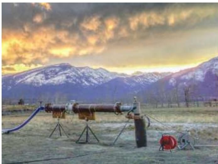
La fotografía muestra una prueba de bombeo que se lleva a cabo en un acuífero constituido por arena y grava no confinado en el valle de Bitterroot, Montana occidental, EE. UU. La fotografía se utiliza con permiso de la Oficina de Minas y Geología de Montana (2023).
