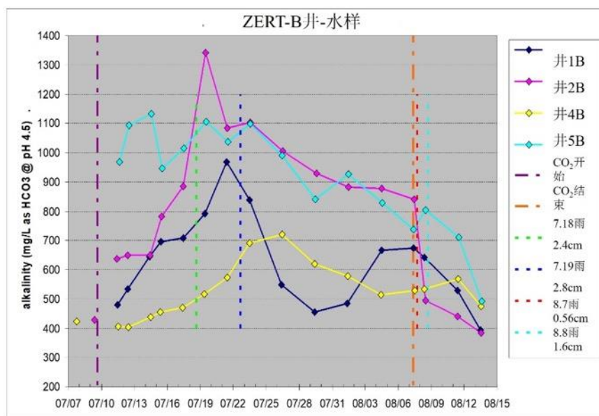
图 96 CO 2 注入前后 ZERT 场址浅层监测井 (B) 水样的碱度变化 (Kharaka et al., 2010)
