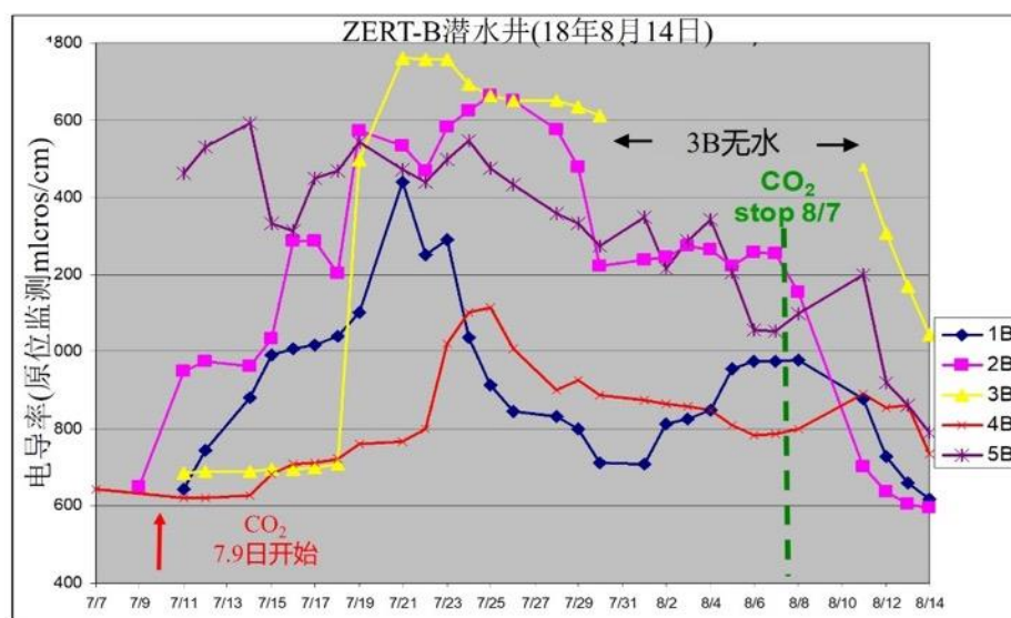
图 97 CO 2 注入前后 ZERT 场址浅层监测井 (B) 水样的导电率变化 (Kharaka et al., 2010)。
