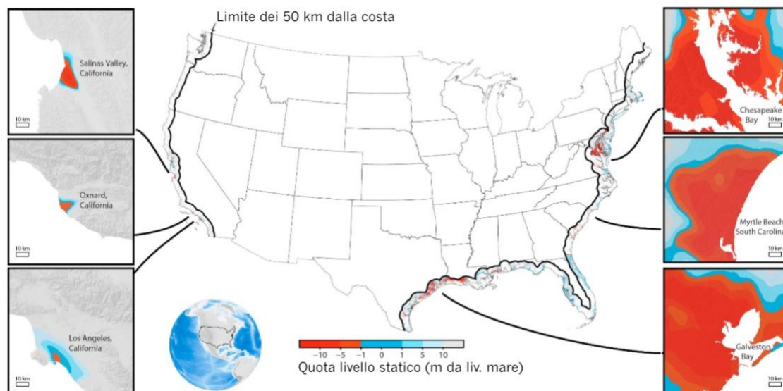
Figura Box 3-1 – Quote pozzo nei vicini Stati Uniti. La mappa al centro mostra la posizione dei pozzi fino a 50 km dalla costa, la scala colorimetrica indica il livello statico sopra o sotto (rosso) il livello mare e misurato dopo il primo gennaio 2000. Le misure interpolate sono riportate nelle 6 piccole carte ai lati.
